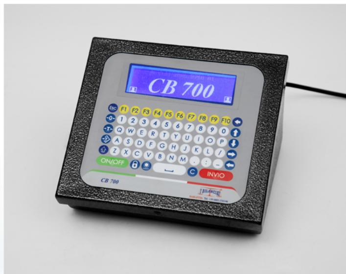
Indicatore di peso compatto ad elevate prestazioni per PESE A PONTE. La sua struttura in acciaio verniciato, lo rende utilizzabile in qualsiasi ambiente industriale. L'indicatore è dotato di display LCD grafico blu, retroilluminato. Tastiera estesa a membrana a 66 tasti. Omologabile CE-M.
