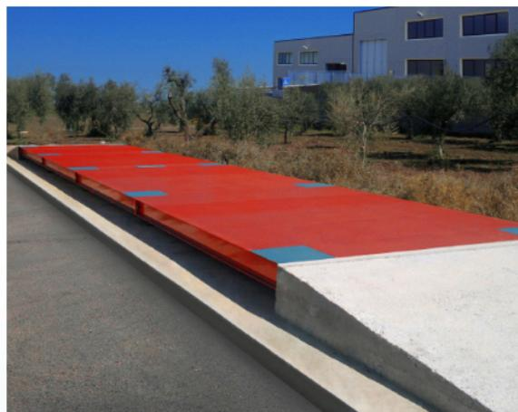
Pesa a ponte modulare verniciata di nuova generazione in versione filo pavimento e sopra pavimento. È adatta in ambito industriale, agricolo e commerciale per la pesatura di automezzi, bilici e autoarticolati. Il piano di carico è realizzato in lamiera bugnate di grosso spessore. Funzionamento con celle di carico IP68. Omologabile CE-M
