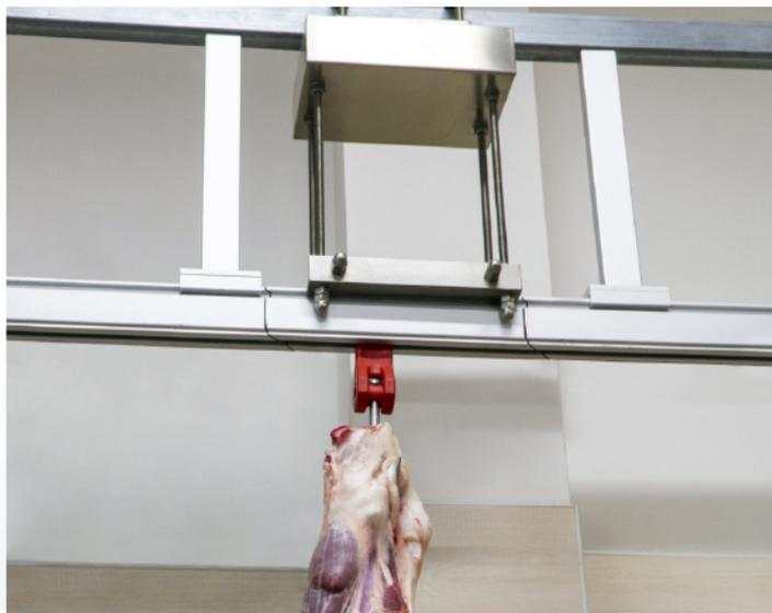
Moduli di pesatura per guidovia, facilmente adattabili a qualsiasi sistema di movimentazione, anche già esistente. Struttura e accessori di fissaggio in acciaio inox. Funzionamento con 2 celle di carico (lunghezza 400 mm).
