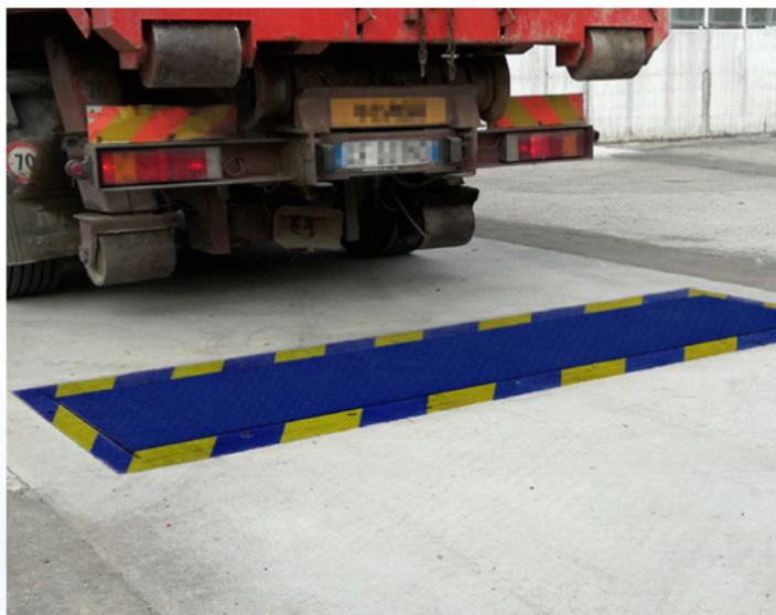
La Piattaforma Pesa assi permette di calcolare il peso di un veicolo in transito sommando i vari assi pesati in modo dinamico. Progettata per installazione a filo pavimento, il piano di carico è realizzato in lamiera bugnate di grosso spessore, il bordo di coronamento è segnaletico. Funzionamento con celle di carico IP68. Omologabile CE-M
