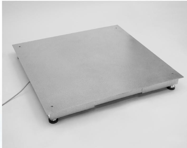
Piattaforma di pesatura elettronica monoblocco in acciaio inox, ideale per tutti i tipi di applicazioni industriali e commerciali. Funzionamento con 4 celle di carico in acciaio inox IP68. La piattaforma è dotata di 4 piedini di appoggio regolabili in acciaio inox e bolla di livello, collegabile a qualsiasi indicatore di peso. Omologabile CE-M.
