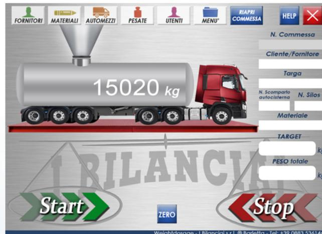
“Weightdosage” è un software che guida l’operatore nelle fasi di dosaggio e permette di gestire le operazioni di pesatura direttamente dal proprio PC, collegandolo all’indicatore di peso, per il dosaggio in carico.
