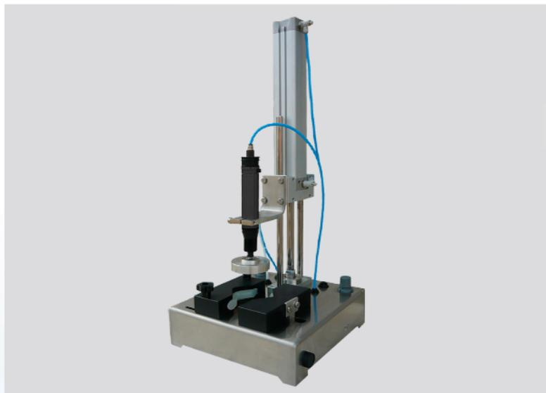
La Tappatrice semiautomatica da banco completa di una testina di tappatura intercambiabile, è idonea per tappi prefilettati in plastica, tappi twist-off e tappi a pressione, realizzata interamente in acciaio inox. Premendo contemporaneamente i due pulsanti laterali, le morse si stringono per far sì che il vaso resti fermo e la testina scenda, avvitando il tappo.
