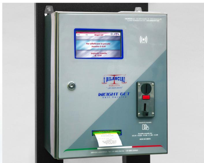
Gettoniera “WEIGHT GET”, indicatore elettronico self service per gestione pesate senza operatore con funzionamento a monete (€) o gettoni. Comprende un display 7” e stampante termica per scontrini. Collegamento diretto a sistema di pesatura. Omologato CE-M.
