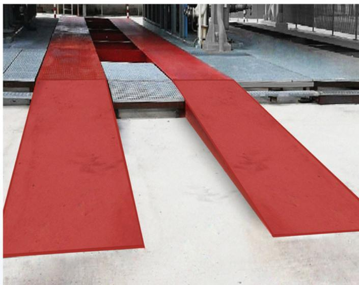
Pesa a ponte modulare a doppia corsia verniciata o zincata a caldo, versione soprapavimento o filopavimento. È adatta in ambito industriale, agricolo e commerciale per la pesatura di automezzi, bilici e autoarticolati. Il piano di carico è realizzato in lamiera bugnate di grosso spessore. Funzionamento con celle di carico IP68. Omologabile CE-M
