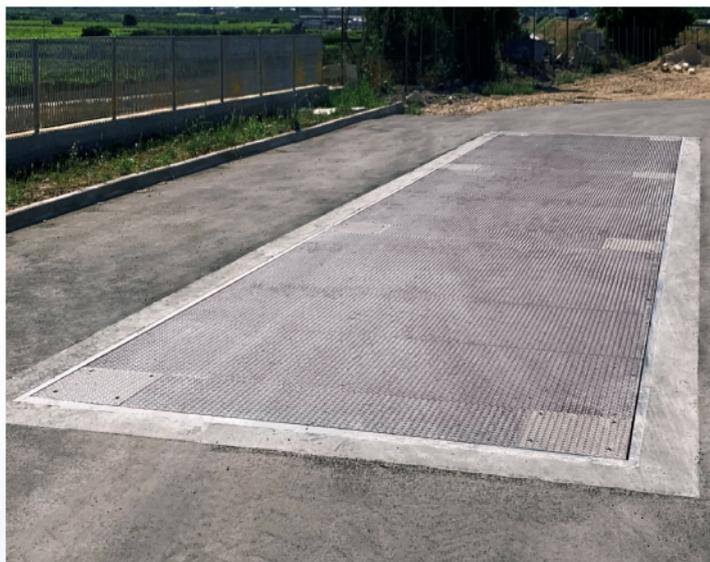
Pesa a ponte modulare zincata a caldo di nuova generazione in versione filo pavimento e sopra pavimento. È adatta in ambito industriale, agricolo e commerciale per la pesatura di automezzi, bilici e autoarticolati. Il piano di carico è realizzato in lamiera bugnate di grosso spessore. Funzionamento con celle di carico IP68. Omologabile CE-M.
