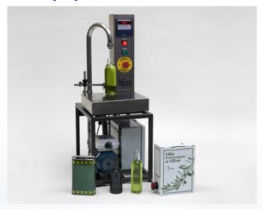
La Micra è una riempi pesa lattine e bottiglie usata dalle aziende sia per uso industriale che per uso commerciale, ideale per l'olio extra vergine d'oliva. La macchina è dotata di colonna e piatto bilancia in acciaio inox, pompa autoadescante e visualizzatore elettronico del peso. Ha come punti di forza le dimensioni ridotte e i costi contenuti, facilità di utilizzo, maneggevolezza e alta precisione. Omologabile CE-M.
