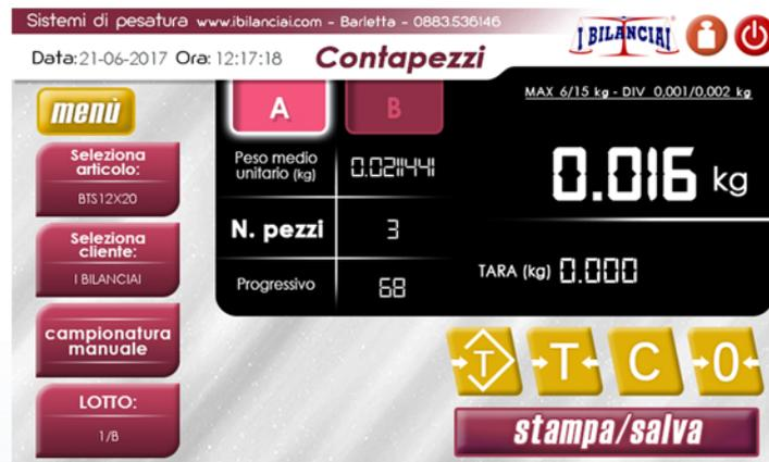
Software “Contapezzi” per conteggio quantità e gestione dati, con archivi, articoli, clienti, lotti e con possibilità di effettuare la campionatura manuale. Possibilità di gestione doppia bilancia, una di campionamento ed una di pesatura. Software ideale per chi si occupa di inventario e magazzino. Disponibile sia su CBTouch che su PC.
